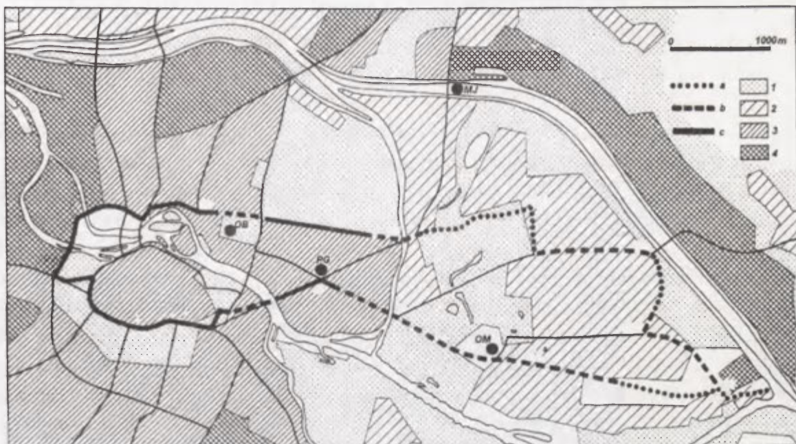
Ryc. 4. Rodzaj użytkowania terenu (1, 2, 3, 4) oraz stanowiska pomiarów sodarowych (OM, PG, OB., MJ) i wartości różnicy temperatury powietrza (a, b, c) między Obserwatorium a punktami pomiarowymi na trasie badań patrolowych (podczas przejazdu stacji meteorologicznej) we Wrocławiu, w warunkach inwersji przygruntowej, w dniu 10.06.2000
