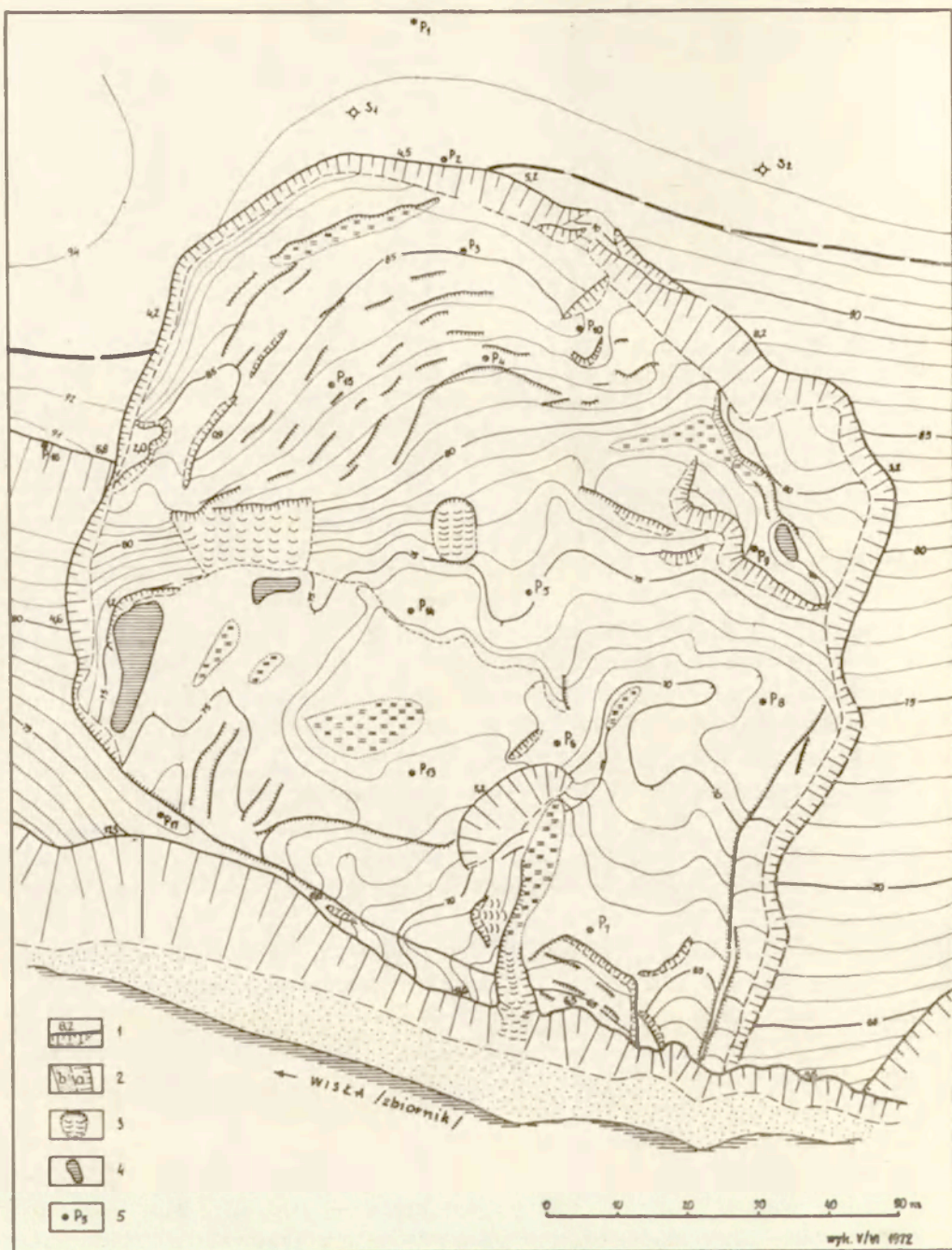
Ryc. 29. Plan osuwiska—zsuwu w Bachorzewie — 664,2 km
