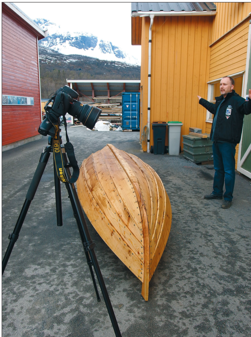
Ryc. 2. Dokumentacja fotogrametryczna małej łodzi drewnianej w centrum żeglugi „Nordnorsk Fartoyvernsent” w Gratangen, Norwegia. Fot. R. Domżał
