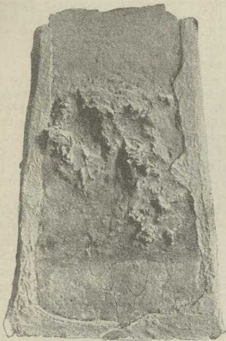
Ryc. 1. Przekrój przedhistorycznego pieca do topienia żelaza z Siedlemina, w pow. jarocińskim. Około \frac{1}{4} wielkości naturalnej. (Coupe d'un fourneau de fusion de fer de Siedlemin, distr. de Jarocin. \frac{1}{4} gr. nat.)
