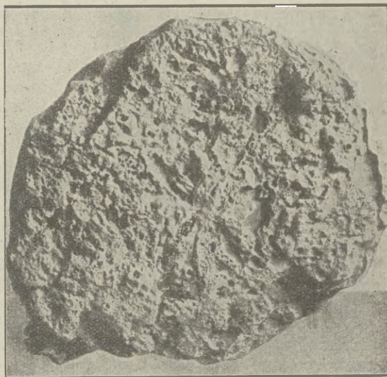
Ryc. 2. Placek stopionej rudy żelaznej z pieca do topienia żelaza w Siedleminie, w pow. jarocińskim ( \frac{2}{13} w. nat.). Pièce de fer fondu d'une fournaise préhistorique de Siedlemin, distr. de Jarocin ( \frac{2}{13} gr. nat.)
