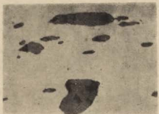
Ryc. 26. Groszowice, pow. opolski. Struktura grota włóczni: a — ferryt i perlit, pow. 100 ×; b — wtrącenia żużla, nie trawione, pow. 500 ×
