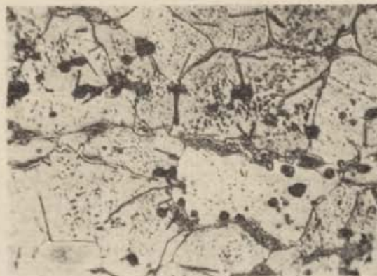
Ryc. 31. Szczedrzyk, pow. opolski. Struktura zapinki nr 2: ferryt, ślady perlitu, wydzielenia iglastej fazy A ( \gamma' -Fe 4 N?) i drobnej fazy B ( \alpha'' -Fe 16 N 2 ?) oraz wtrącenia żużla, pow. 500 ×
