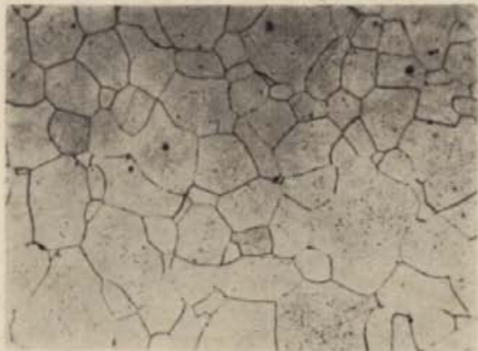
Ryc. 19. Tarnów, pow. opolski. Struktura ostrogi nr 2: ferryt, pow. 100 X
