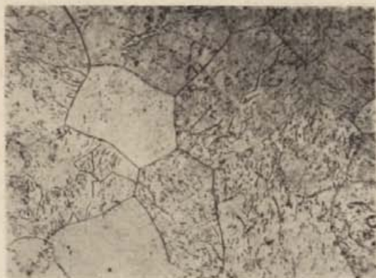
Ryc. 17. Tarnów, pow. opolski. Struktura zapinki nr 2: ferryt i wydzielenia fazy B ( \alpha —Fe 16 N 2 ?), pow. 100×. Fig. 17. Tarnów, distr. d'Opole. Structure de la fibule N° 2: ferrite et précipitations de la phase B ( \alpha —Fe 16 N 2 ?), ×100
