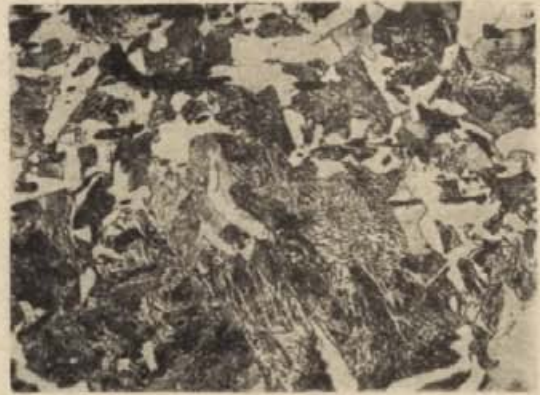
Ryc. 14. Tarnów, pow. opolski. Struktura noża nr 4: perlit, ferryt i wtrącenia żużla, pow. 100\times
