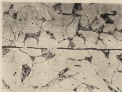
Ryc. 18. Tarnów, pow. opolski. Struktura zapinki nr 3 (z grzebykiem): ferryt, perlit oraz wtrącenia żużla, pow. 100×. Fig. 18. Tarnów, distr. d'Opole. Structure de la fibule N° 3: ferrite, perlite et inclusions de la scorie, ×100
