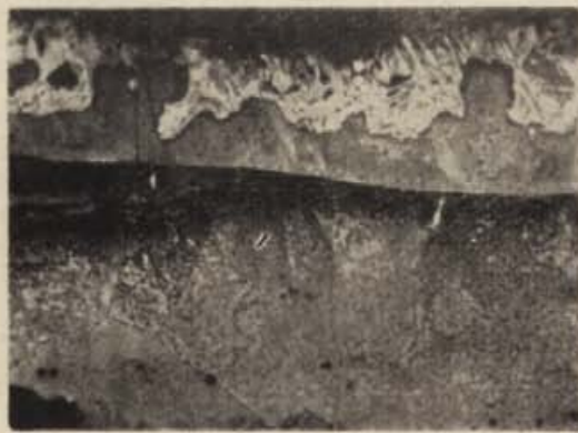
Ryc. 20. Tarnów, pow. opolski. Struktura zapinki nr 4, „norweskiej”: a — ferryt, wydzielienia (?) nieokreślonej fazy wokół wtrąceń żuźła, pow. 500 X; b — przy powierzchni po wytrawieniu roztworem chlorku żelaza: od strony żelaza ziarna roztworu \alpha , na powierzchni (u góry) jasne wydzielienia eutektoidu \delta , pow. 100 X
