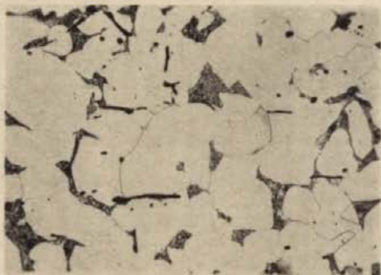
Ryc. 6. Rogów, pow. opolski. Struktura grota włóczni: ferryt, perlit i wtrącenia żużla, pow. 100 \times
