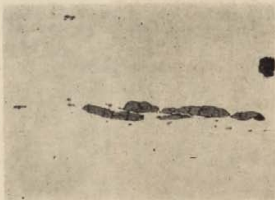
Ryc. 7. Tarnów, pow. opolski. Struktura zapinki nr 1: a — perlit, ferryt i wtrącenia żużla, pow. 100 \times ; b — wtrącenia żużla, nie trawione, pow. 500 \times
