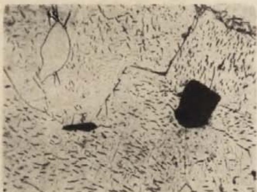
Ryc. 5. Nowa Wieś, pow. opolski. Struktura noża: a — ferryt, perlit i wtrącenia żużla, pow. 100 \times ; b — (przy powierzchni) ferryt, wydzielenia fazy B ( \alpha'' -Fe 16 N 2 ?) i wtrącenia żużla, pow. 500 \times
