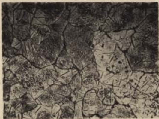
Ryc. 8. Tarnów, pow. opolski. Struktura umba: ferryt, wydzielenia fazy A ( \gamma - Fe 4 N?) i fazy B ( \alpha'' - Fe 16 N 2 ?) oraz drobne wtrącenia żużła; a — próbka z umba; b — próbka z nita; pow. 100 ×
