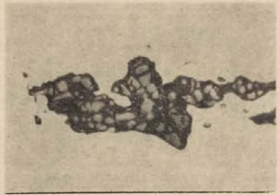
Ryc. 23. Krapkowice, pow. opolski. Struktura nożyc: c — ferryt i wtrącenia żużla, pow. 100 ×; b — wtrącenia żużla, nie trawione, pow. 500 ×
