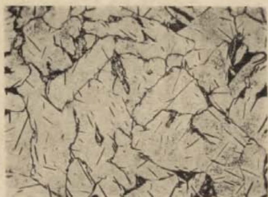
Ryc. 15. Tarnów, pow. opolski. Struktura wisiorka: a — blaszka, ferryt i ślady perlitu, wydzielenia fazy A ( \gamma' - \text{Fe}_4\text{N} ) oraz wtrącenia żużla, pow. 100\times ; b — struktura żużla (blaszka), nie trawione, pow. 500\times ; c — struktura warstwy miedzi (blaszka), pow. 100\times ; d — kablak: ferryt, ślady perlitu, wydzielenia fazy A ( \gamma' - \text{Fe}_4\text{N} ?), pow. 100\times
