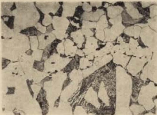
Ryc. 26. Groszowice, pow. opolski. Struktura grota włóczni: a — ferryt i perlit, pow. 100 ×; b — wtrącenia żużla, nie trawione, pow. 500 ×
