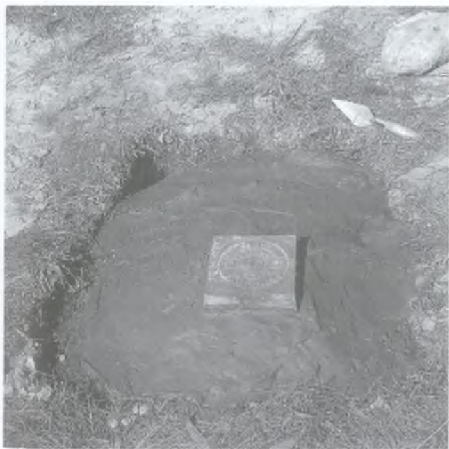
Ryc. 43. Krzemionki Opatowskie. Znak pomiarowy 250 (204,53 m n.p.m.), stabilizujący siatkę geodezyjną, założoną w sierpniu 1979 r. na początku badań tzw. „magistrali”, bezpośrednio po zabetonowaniu. Zamyka on 250 metrowy odcinek „magistrali” w pobliżu przyszłego szybu „0”. Fot. J. Lech.
