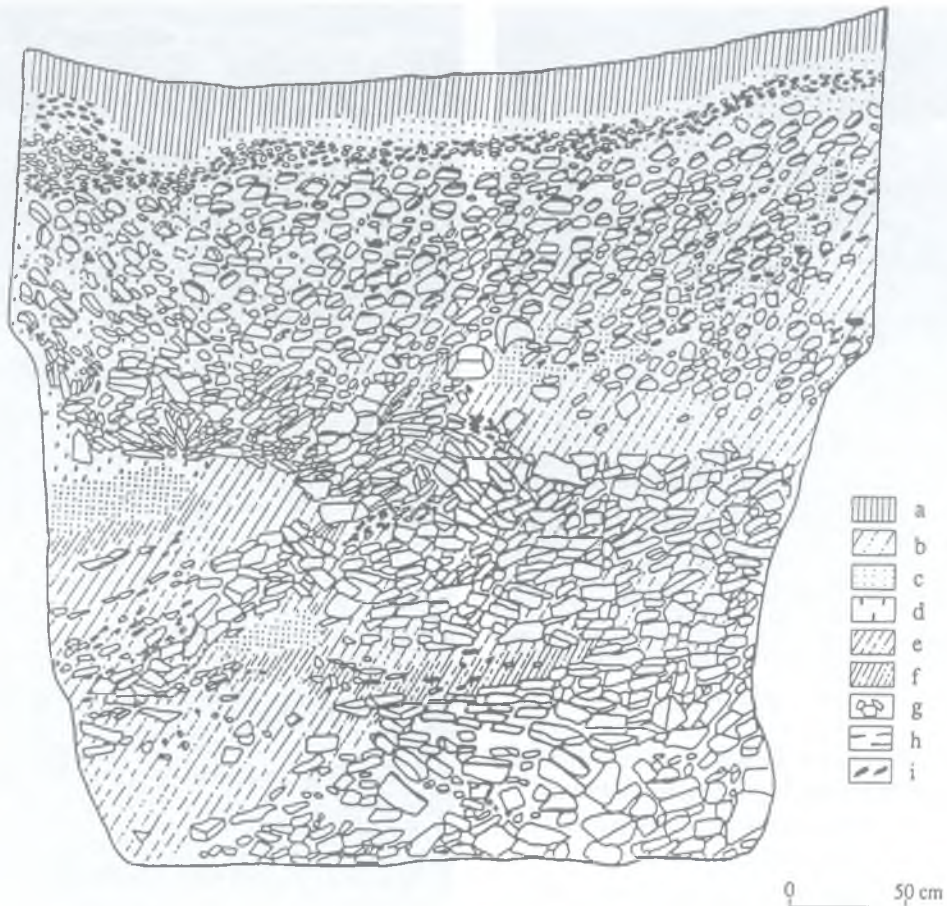
Ryc. 28. Krzemionki Opatowskie. Profil szybu 8/669 zamieszczony przez W. Migala (Ryc. 7 ze s. 77). a – humus, b – piasek szary, c – piasek ciemnoszary, d – glina czerwono-brązowa, e – glina czerwona z drobnym gruzem wapiennym, f – glina czerwona z miałem wapiennym, g – gruby gruz wapienny, h – skała wapienna, i – krzemień.
