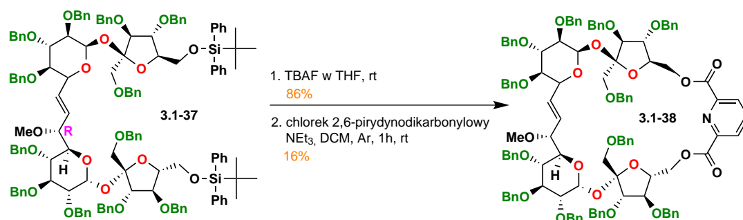
Rysunek 3.28: Udana próba domknięcia pierścienia makrocyklicznego.
