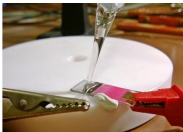
Rys. 12.68 Fotografia układu pomiarowego dla elektrod paskowych TMA-CNP(6)-TPS-TMOS-AChE z elektrodą chlorosrebrową umieszczoną w pipecie szklanej.
