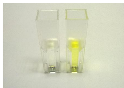
Rys. 12.1 a) Widmo UV-Vis przedstawiające pik przy długości fali 412 nm pochodzący od barwnego, żółtego produktu reakcji tiocholiny z DTNB, b) kuweta pomiarowa przed i po dodaniu TC (żółty roztwór).
