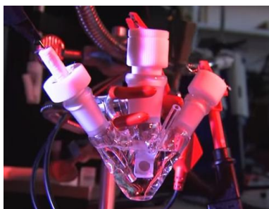
Rys. 11.1 Trójelektrodowy układ pomiarowy służący do detekcji dopaminy.
