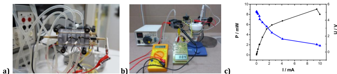
Rys. 4.9 a) Fotografia układu trzech przepływowych ogniw Hy-Zn-O 2 , b) fotografia systemu zasilającego czujnik podłączonego do mini-potencjostatu wykonanego w warunkach domowych, c) charakterystyka prądowo-napięciowa układu trójogniowego, bufor McIlvaina pH = 5,3 33 .
