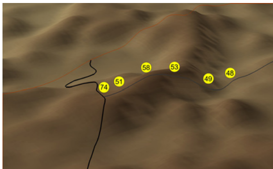
Ryc. 8.5. Wartości średniego, równoważnego poziomu dźwięku ( L_{Aeq} ) na profilu „Budzisko” w różnych odległościach od krawędzi jezdni
