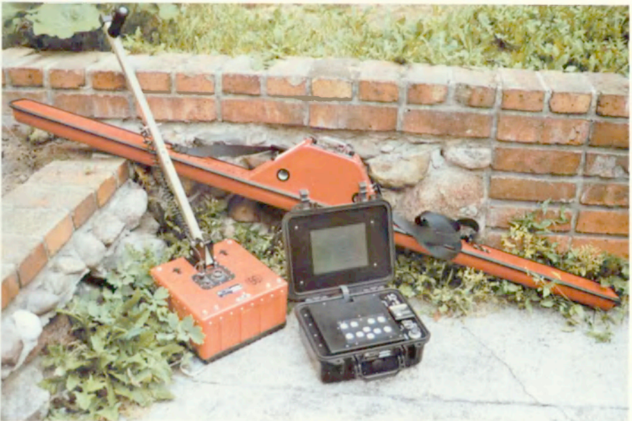
Fot. 2. Aparatura georadarowa najnowszej generacji (SIR-2000) oraz współczesne anteny radarowe (czerwone). Powyżej antena 35 MHz, poniżej – 400 MHz
