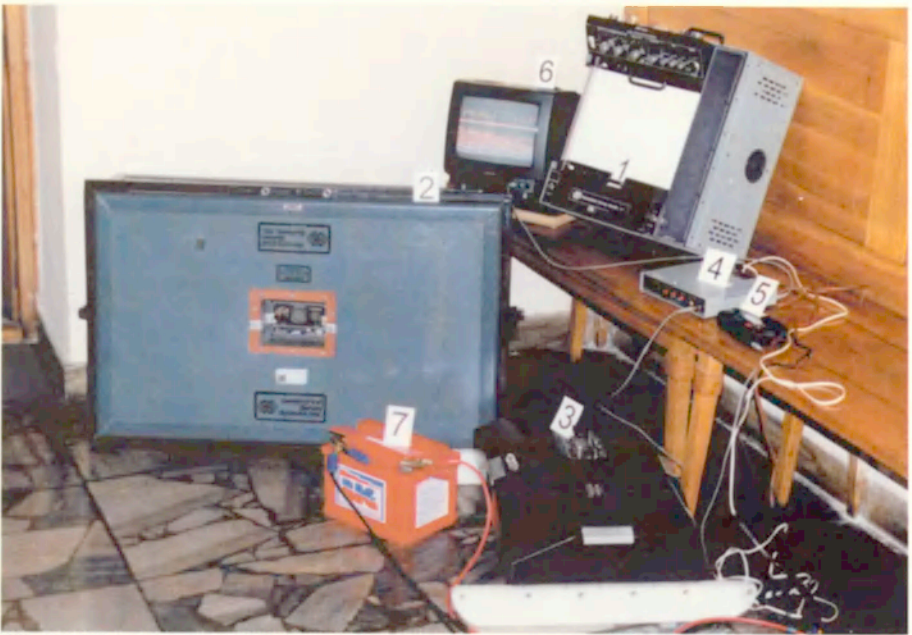
Fot. 1. Części składowe aparatury georadarowej SIR SYSTEM-3. 1 – jednostka centralna radaru, 2, 3 – anteny, 4, 5, 6 – urządzenia wizualizacji i gromadzenia danych, 7 – akumulator
