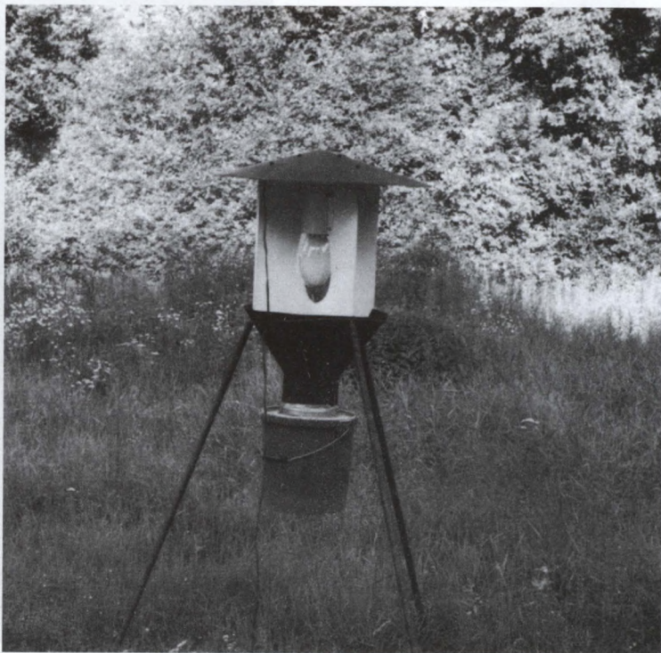
Fig. 10. A light-trap for sampling lepidopterans in the Forest District Szkółkarskie (Kotowa Wola)
