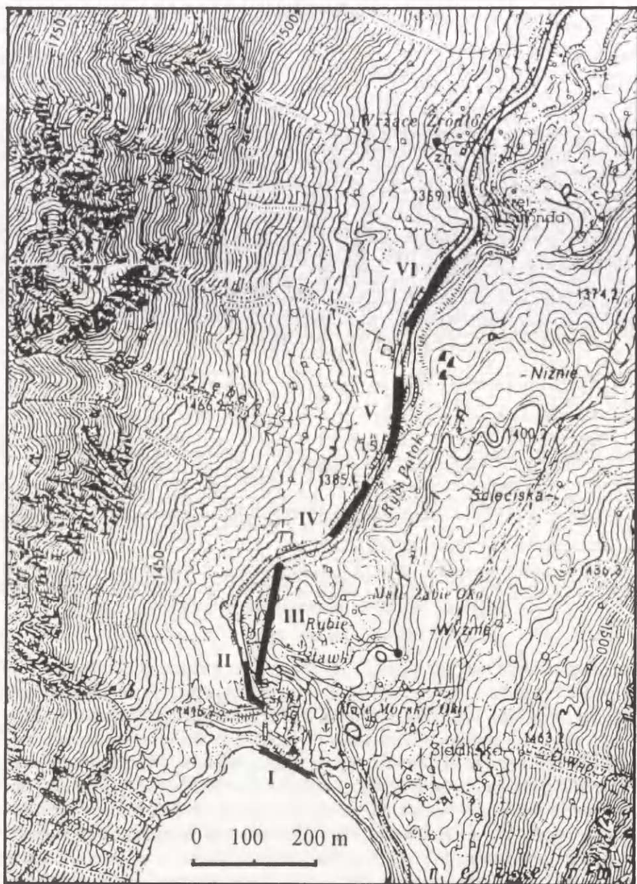
Ryc. 10. Lokalizacja profilów refrakcyjnych w Dolinie Rybiego Potoku od schroniska PTTK po Zakręt Ejsmonda na tle mapy sytuacyjno-wysokościowej, OPGK, Kraków, 1965
