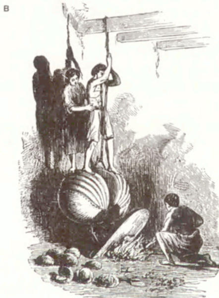
Ryc. 35. Wytop żelaza w pierwszej połowie XIX w. w zlewni Umiew A – piec z nadbudową szybową (Cracroft 1832), B – ognisko bez nadbudowy szybowej (Hooker 1854), w lewym dolnym rogu widać wytopione łupki żelaza Smelting of iron in the first half of the XIX c. in the Umiew catchment A – furnace (Cracroft 1832), B – open fire, in the left bottom corner smelted lumps are visible (Hooker 1854)
