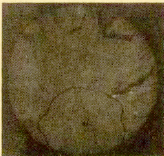
Rys. 14. Przełom izolatora długopniowego wykazujący wtrącenie ciała obcego i przylegający do niego obszar kruchych pęknięć [2]
