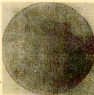
Rys. 13. Szlifowany i trawiony w kwasie fluorowodorowym przełom izolatora długopniowego wykazujący po głębokim trawieniu wady tekstury na całej powierzchni [2]
