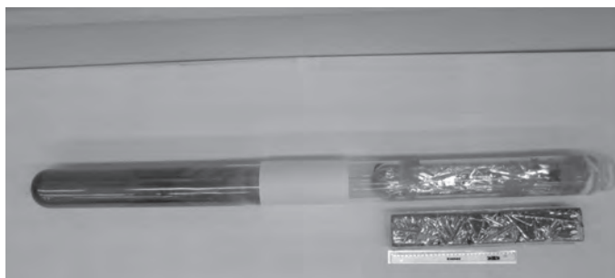
Fot. 2. Widok reaktora kwarcowego i polikrystalicznego wlewka InP o masie ~ 5000 g po procesie syntezy (linijka o długości 30cm).
