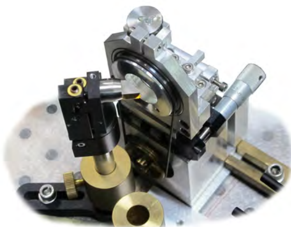
Rysunek 3.41: Zdjęcie uchwytu próbki – przed kuetą znajduje się zwierciadło M7 zamontowane w kiwaczu 1 umieszczonym na uchylniej platformie.
