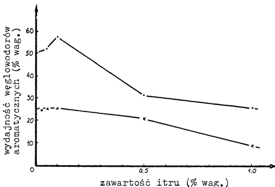
Rys.9. Wpływ dodatku itru na aktywność katalizatora Pt/Al 2 O 3 w reakcji odwodornienia cykloheksanu (—●—) i dehydrocyklizacji n-oktanu (—x—)
