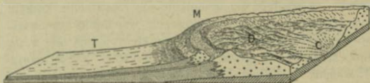
Schemat moreny czołowej (M). Na prawo (z tyłu) od niej leżą osady moreniczne (D), dalej osady moreny dennej (C). Na lewo (przed czołem moreny leżą) piaski sandrowe (T).
