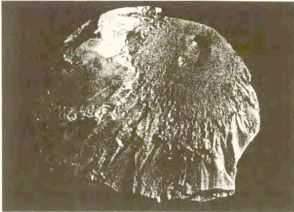
Bild 24. Fehler im Stamm eines Isolators mit charakteristischem Gebiet der spröden Risse.
