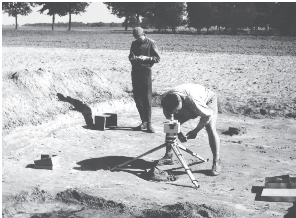
Ryc. 7. Wesółki. W. Stopiński wykonuje pomiary parametryczne wagą magnetyczną nad grobem nr 3 z wyposażeniem żelaznym (składowa \Delta Z = 457 \gamma ).
