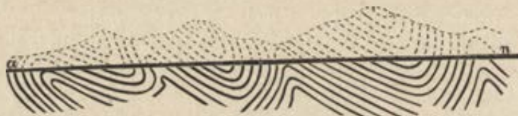
Fig. 66. Równina abrazji (część gór zniszczona jest kropkowana).
