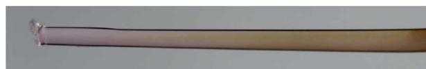
Rys. 2.1.4. Zdjęcie kompozytu szklanego NBP otrzymanego z roztopu zawierającego 0,2 % wag. nanocząstek srebra i 3 % wag Er_2O_3 po zastosowaniu młynka planetarnego.
