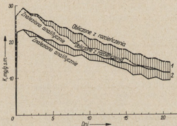
Rys. 20. Przebieg zawartości potasu w wodzie akwariów i teoretycznie obliczona ich zawartość na skutek stosowania uzupełnień wodą destylowaną.
