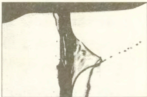
Rysunek 3.6: Tworzenie się stabilnych błon oderwanych od silnie parującej powierzchni strugi alkoholu; r_j = 50\mu\text{m} , P_\infty = 100\text{Pa} , X = 0 , V_j = 3\text{m/s} .
