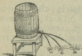
Fig. 47. W miarę wypróżnienia się beczki strumień wody słabnie i zbliża się od a do c .
