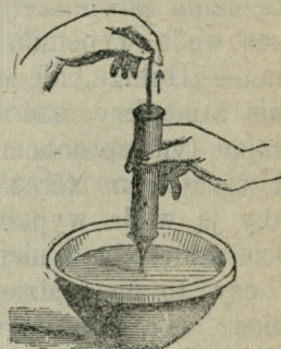
Fig. 64. Woda z miski pod wpływem ciśnienia powietrza wznosi się do wnętrza szprycy.
