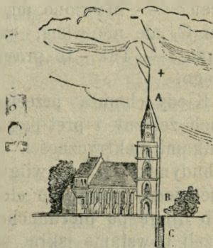
Fig. 17. Piorun zwykle uderza w ostrze i po przewodniku AB dąży do ziemi.
