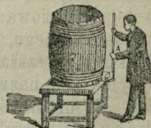
Fig. 66. Woda w rurce zatrzymuje się na tej samej wysokości (A), na jakiej stoi w beczce.
