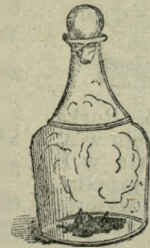
Fig. 54. Powietrze rozszerzyło się wskutek ciepła spalonego papieru. Po nałożeniu jajka wytworzyła się częściowa próżnia, w którą ciśnienie atmosferyczne wgniało jajko.
