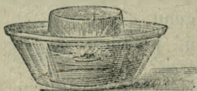
Fig. 16. Fosfor paląc się, zabrał wszystek tlen. Pod kloszem zostaje już tylko czysty azot.
