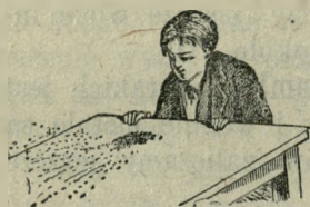
Fig. 5. Dmuchając ostrożnie możemy oddzielić siarkę od żelaza: mieszanina.
