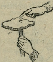
Fig. 7. Zbliżam palec do potartej żywicy; widzicie, że wyskakuje z niej małeńka iskra, przyczem słyhać słaby, głuchy trzask.
