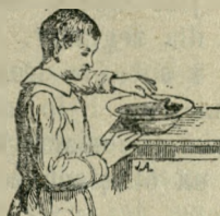
Fig. 36. Kaczka zbliża się lub oddala, zależnie od tego, który koniec magnesu zbliżamy do niej.
