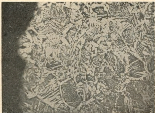
Ryc. 3. Struktura przy nawęglonej (?) powierzchni ostrza czekana z Duplisk, pow. Zaleszczyki: perlit i ferryt. Traw. azotalem, pow. 100×
