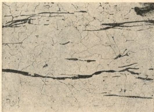
Ryc. 4. Struktura nienawęglonej części czekana z Duplisk: ferryt o dość drobnym ziarnie. Traw. azotalem, pow. 100×
