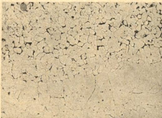
Ryc. 10. Struktura liścia grota włóczni z Rezyn, pow. Humań: gruboziarnisty i drobnoziarnisty ferryt ze śladami perlitu na granicach ziarn. Traw. azotalem, pow. 100×
