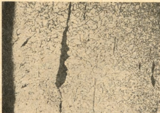
Ryc. 20. Struktura przy powierzchni (na lewo) noża z Bahwy: ferryt, skoagulowany cementyt eutektoidalny i wtrącenia żużla. Traw. azotalem, pow. 100×
