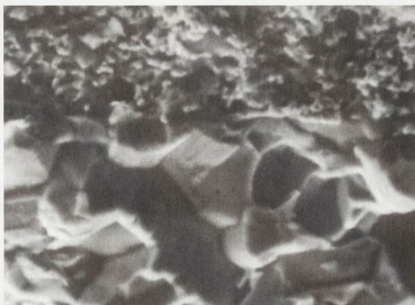
Rys. 8.7. Wygląd przełomu ścieżki metalicznej wykonanej z proszku wolframu na ceramice korundowej ( \sim 92\% \text{Al}_2\text{O}_3 ) po spieczeniu, SEM 2000x.
