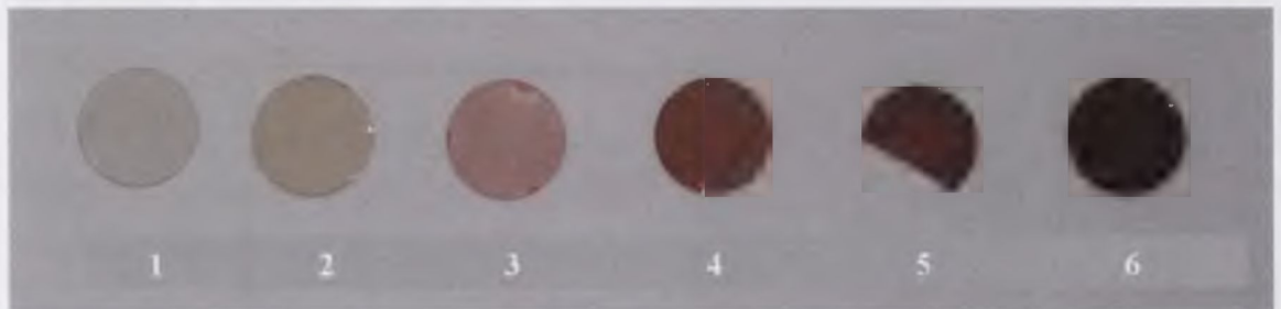
Rys. 8.6. Zdjęcie struktur epitaksjalnych \text{Cr,Mg} :GGG/GGG otrzymanych ze składów, w których: 1 – \text{Cr}/\Sigma = 2,9 \times 10^{-5} , \text{Cr}/\text{Mg} = 0,06 ; 2 – \text{Cr}/\Sigma = 0,002 , \text{Cr}/\text{Mg} = 0,5 ; 3 – \text{Cr}/\Sigma = 0,0028 , \text{Cr}/\text{Mg} = 0,6 ; 4 – \text{Cr}/\Sigma = 0,0045 , \text{Cr}/\text{Mg} = 1,0 ; 5 – \text{Cr}/\Sigma = 0,0116 , \text{Cr}/\text{Mg} = 2,5 ; 6 – \text{Cr}/\Sigma = 0,013 , \text{Cr}/\text{Mg} = 10,0 .
