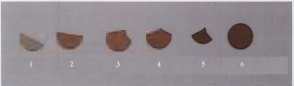
Rys. 8.5. Zdjęcie struktur epitaksjalnych \text{Cr,Mg} :YAG/YAG otrzymanych ze składów, w których: 1 – \text{Cr}/\Sigma = 0,009 , \text{Cr}/\text{Mg} = 10,0 ; 2 – \text{Cr}/\Sigma = 0,009 , \text{Cr}/\text{Mg} = 2,5 ; 3 – \text{Cr}/\Sigma = 0,013 , \text{Cr}/\text{Mg} = 3,3 ; 4 – \text{Cr}/\Sigma = 0,013 , \text{Cr}/\text{Mg} = 2,0 ; 5 – \text{Cr}/\Sigma = 0,018 , \text{Cr}/\text{Mg} = 3,0 ; 6 – \text{Cr}/\Sigma = 0,024 , \text{Cr}/\text{Mg} = 4,0 .
