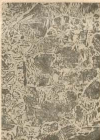
Ryc. 22. Struktura siekierki nr 1 ze Szczonow (traw. azotalem): a — jeszcze dalej od krawędzi tnącej ostrza: ferryt i niewielkie ilości perlitu oraz wtrącenie żuźla, 100 \times ; b — jak a pod większym powiększeniem, 500 \times ; c — jeszcze dalej od krawędzi tnącej ostrza: ferryt oraz drobne wtrącenia żuźla, 100 \times ; d — tuleja siekierki: perlit i ferryt. 100 \times
