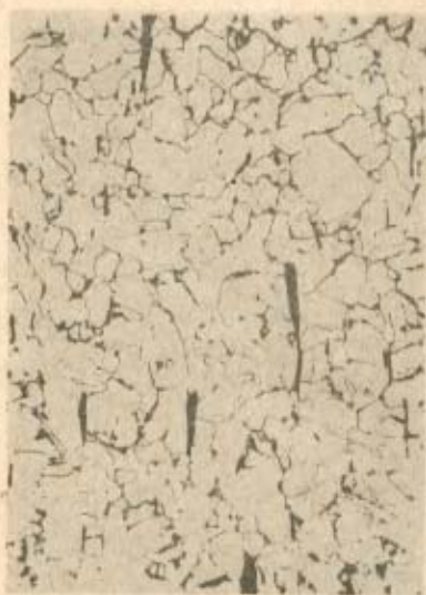
Ryc. 22. Struktura siekierki nr 1 ze Szczonow (traw. azotalem): a — jeszcze dalej od krawędzi tnącej ostrza: ferryt i niewielkie ilości perlitu oraz wtrącenie żuźla, 100 \times ; b — jak a pod większym powiększeniem, 500 \times ; c — jeszcze dalej od krawędzi tnącej ostrza: ferryt oraz drobne wtrącenia żuźla, 100 \times ; d — tuleja siekierki: perlit i ferryt. 100 \times
