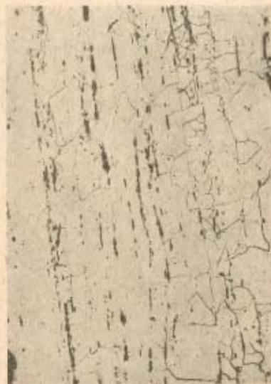
Ryc. 31. Struktura bransolety ze Słupcy (a, b) oraz sierpa nr 1 (c) i nr 2 (d) z Biskupina (traw. azotalem): a — perlit sorbityczny (?) i perlit pasemkowy, 100 \times ; b — w pobliżu wtrącenia tlenkowego: ferryt i perlit, 100 \times ; c — ferryt i wtrącenia żużla, 100 \times ; d — ferryt i wtrącenia żużla, 100 \times
