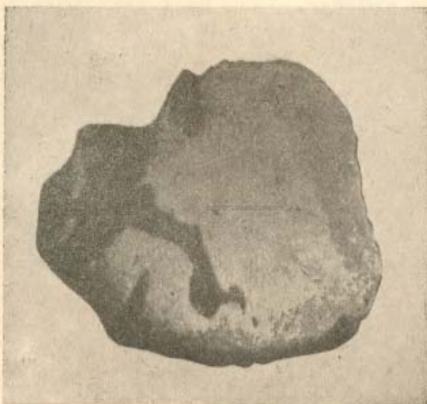
Ryc. 16. Makrostruktura na poprzecznym przekroju bransolet (traw. azotalem; miejsca bardziej nawęglone uległy silniejszemu wytrawieniu): a — bransoleta nr 1 ze Szczonowa, 8 ×; b — bransoleta nr 2 ze Szczonowa, 6 ×
