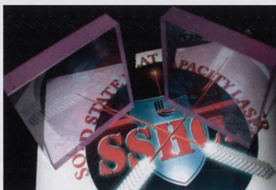
Rys. 1.8. Elementy polikrystalicznego Nd:YAG o rozmiarze 10 cm/10 cm i grubości 2 cm wykorzystane do budowy lasera o wysokiej mocy w Lawrence Livermore National Laboratory [29]
