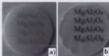
Rys. 4.68. Spieki \text{MgAl}_2\text{O}_4 otrzymane na drodze spiekania pod ciśnieniem w temperaturze 1600^\circ\text{C} z dwugodzinnym przetrzymaniem, minimalne ciśnienie (10 MPa) przyłożone w temperaturze 1000^\circ\text{C} , maksymalne ciśnienie (30 MPa) osiągnięte zostało w temperaturze 1300^\circ\text{C} (1% LiF), szybkość wzrostu temperatury w czasie przykładania ciśnienia a) 10^\circ/\text{min} , b) 20^\circ/\text{min}
