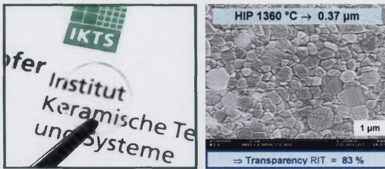
Rys. 2.12. Zdjęcie próbki MgAl 2 O 4 spiekanej swobodnie a następnie dogęszczonej HIP oraz mikrofotografia SEM jej mikrostruktury [56]
