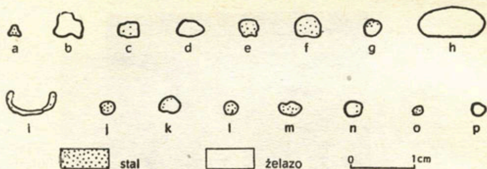
Ryc. 2. Ocena stopnia nawęglania zbadanych zapinek lub ich fragmentów:
