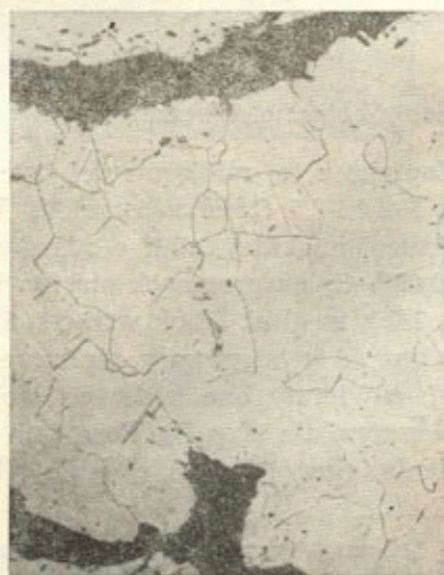
Ryc. 13. Nowa Cerekwia, pow. Głubczyce. Struktura zapinki 7: a — część silniej nawęglona: ferryt, ślady perlitu i wtrącenia żużla; b — część słabiej nawęglona: ferryt i wtrącenia żużla; traw. azotalem, pow. 100x
