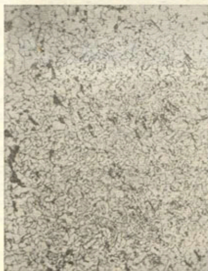
Ryc. 13. Nowa Cerekwia, pow. Głubczyce. Struktura zapinki 7: a — część silniej nawęglona: ferryt, ślady perlitu i wtrącenia żużla; b — część słabiej nawęglona: ferryt i wtrącenia żużla; traw. azotalem, pow. 100x
