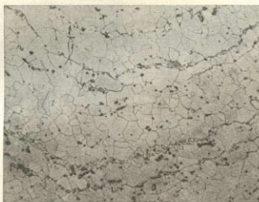
Ryc. 5. Sobocisko, pow. Olawa. Struktura zapinki 3: ferryt, ślady perlitu i wtrącenia żużla, traw. azotalem, pow. 100x
