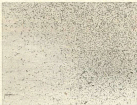
Ryc. 12. Nowa Cerekwia, pow. Głubczyce. Struktura zapinki 6: ferryt, ślady perlitu i wtrącenia żużla, traw. azotalem, pow. 100x
