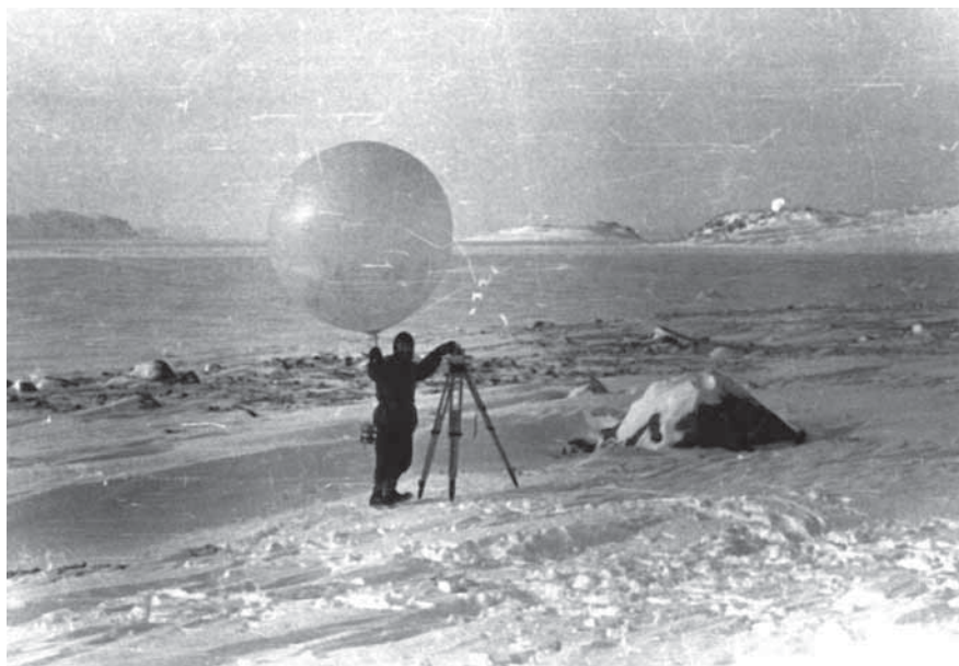
Fot. 2. Puszczanie balonu z radiosondą, stacja „Haudegen” On the release of a radiosonde from “Haudegen” station Fot./Photo: W. Dege, 2.04.1945.
