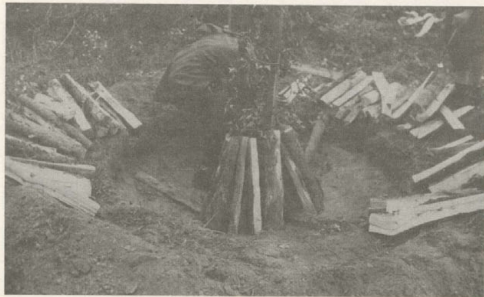
Ryc. 16. Nowa Słupia, gm. Nowa Słupia, woj. Kielce. Początkowa faza budowy mielerza (1962). Fot. K. Bielenin
