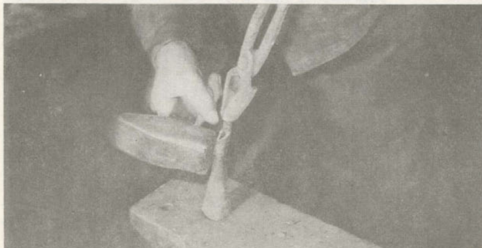
Ryc. 15. Toruń, woj. Toruń. Końcowa faza produkcji grotów beltów do kusz z tulejką podczas eksperymentu (1974). Wg. A. Koli i G. Wilkego (1975, s. 174 ryc. 8c)
