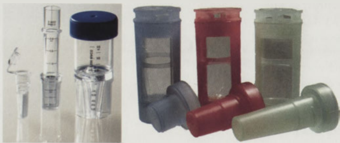
Rycina 1. Koncentratory U-Tube™ o różnych objętościach.
