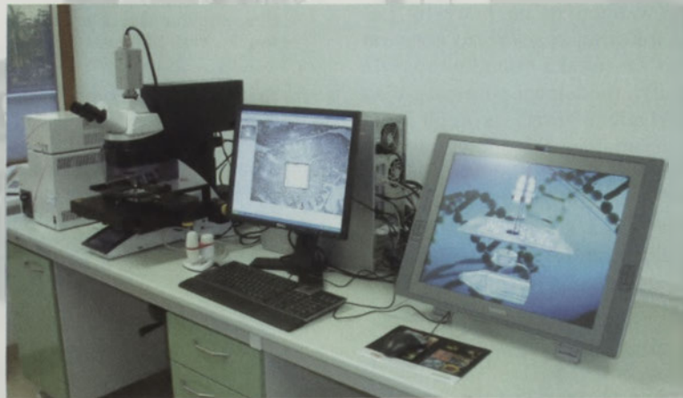
System do mikroskopowej laserowej mikropreparatyki zakupiony do Pracowni Proteomiki i Transkryptomiki
