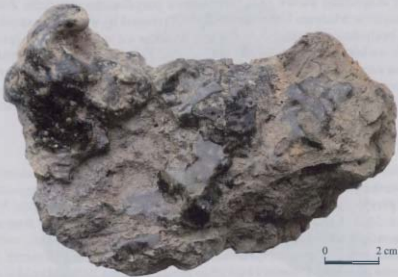
Ryc. 3. Fragment ściany pieca z zachowanymi pozostałościami szkliwa (stan. 89, nr inv. 244, wykop III/65, dz. J).
