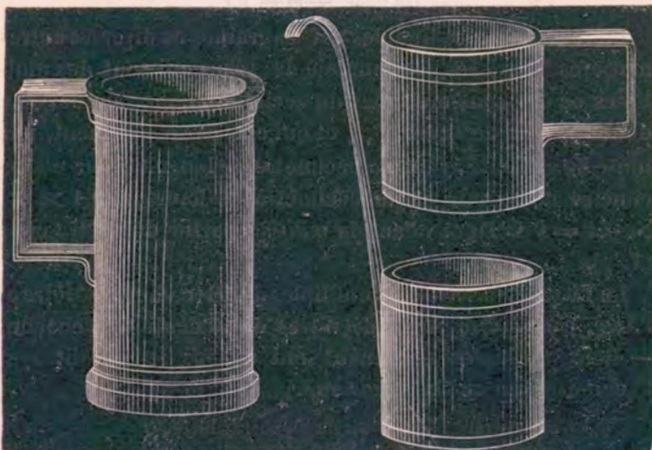
Fig. 6. — Forme du Litre, du Double litre et des autres mesures de capacité plus petites.
