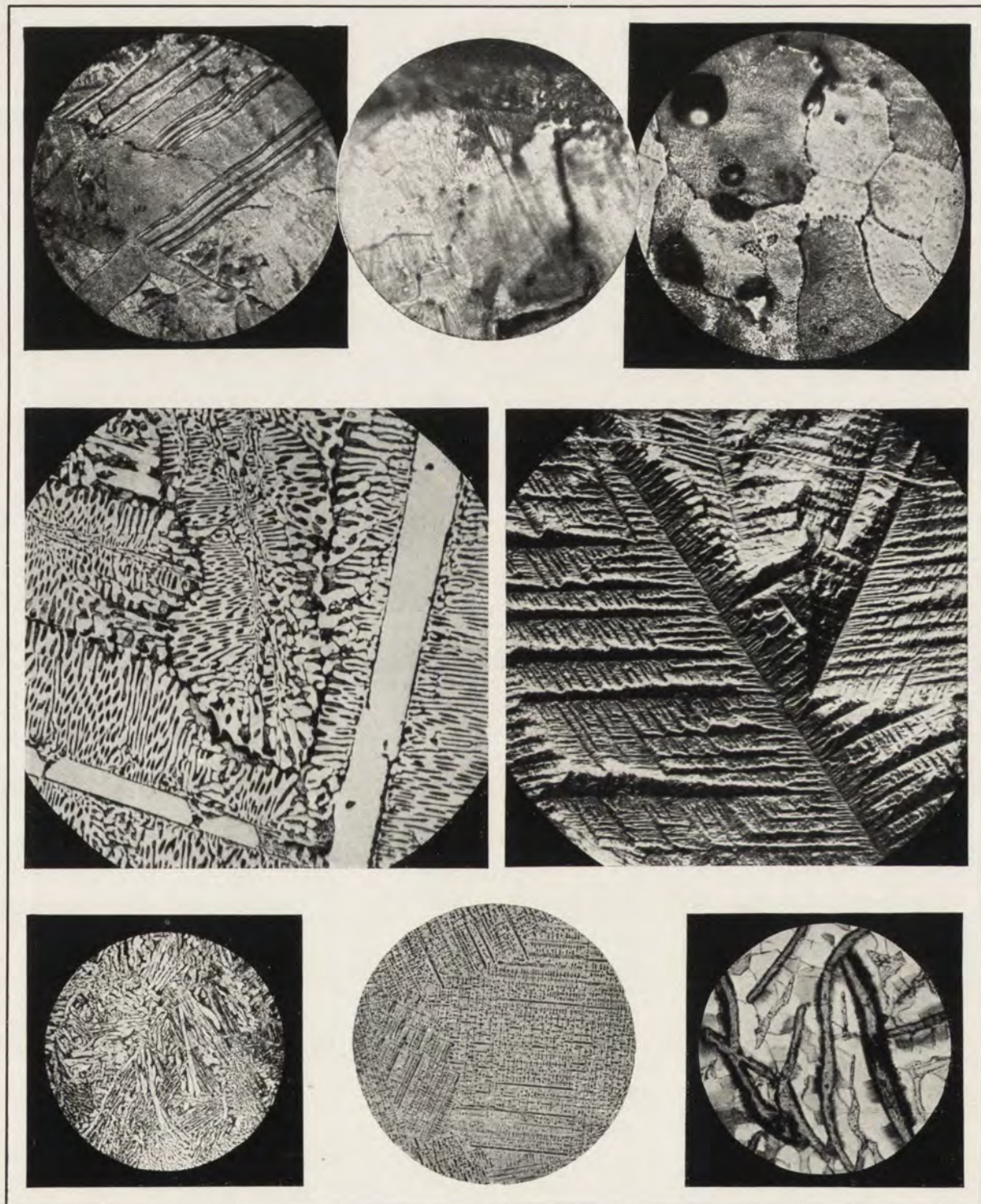
Metalle unter dem Mikroskop. Oben: Schnittstellen von Kupferdraht, 150fach vergrößert. (Aus „Mikrokosmos“, Francksche Verlagshandlung, Stuttgart.) Unten: Struktur von Rotguß, Bronze, Grauguß. (Bei letzterem erkennbar schwarze Adern von Graphit, sowie, heller, Ferrit und phosphorhaltige Einlagerungen) In der Mitte: Siegerländer Spiegeleisen (links) und Oberfläche eines langsam erkalteten Antimonblocks. (Die Bilder in der mittleren und unteren Reihe mit Genehmigung der A. E. G., Berlin.)
