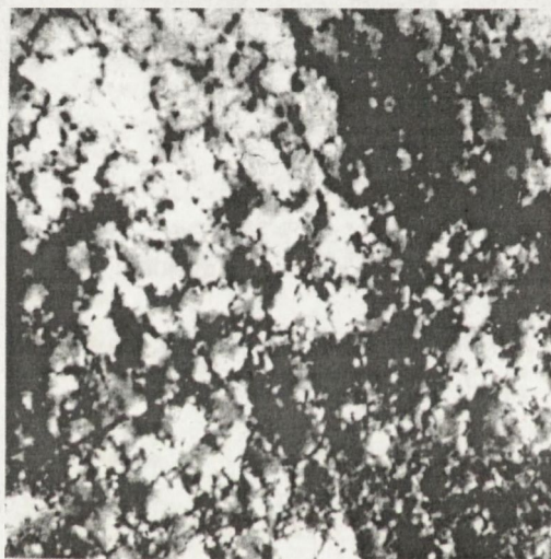
Rys. 34. Powiększony fragment topogramu próbki wyciętej z dolnej partii niedomieszanego kryształu GaAs , wykonany w układzie 511Ge, -511GaAs i pokazujący szczegóły struktury komórkowej.
