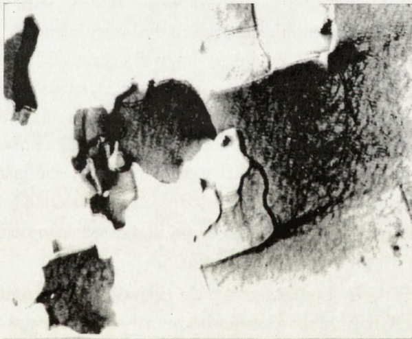
Rys. 36. Powiększony fragment topogramu Berga-Barretta w refleksie 511 \text{ Cu } K\alpha_1 środkowej części płytki wyciętej z niedomieszkowanego monokryształu \text{GaAs} zawierającej rozwiniętą strukturę blokową z dezorientacją bloków dochodzącą do 2^\circ . Na tle bloków widoczna jest struktura komórkowa.
