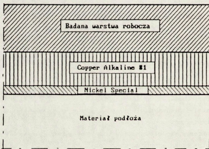
Rys.9. Schemat budowy badanych powłok
