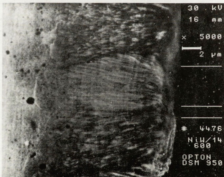
Rys. 17. Mikrostruktura przekroju poprzecznego powłok Ni-W/14
