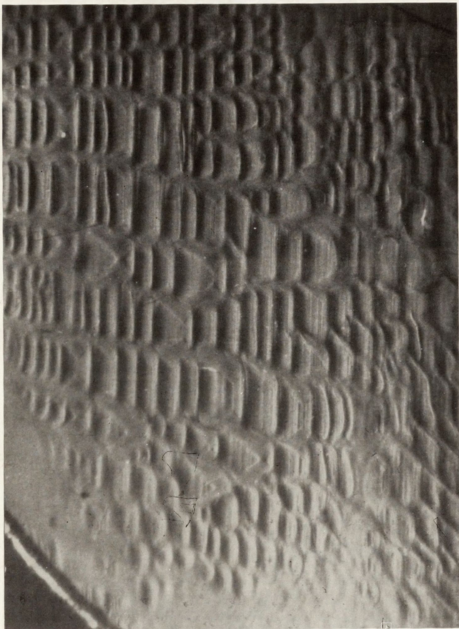
Rys. 19. Topogram transmisyjny Langa próbki z monokryształu GaAs: (Si + In) pokazujący strukturę komórkową a - topogram b - powiększenie fragmentu
