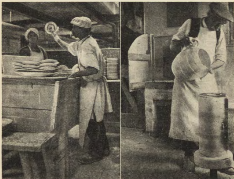
(b) (Na lewo). Zanurzanie. Talerz po wypaleniu pokrywa się cieniutką warstwą gliny plastycznej, która po powtórnej wypaleniu tworzy rodzaj emalii. Robotnik używa dwóch kadzi; w jednej z nich glina polewy jest bardziej gęsta niż w drugiej. Talerze niejednakowo wchłaniają materiał, przeto robotnik winien mieć dużą wprawę, aby mógł ocenić z wyglądu przedmiotu stopień nasycenia polewą. (c) (Na prawo). Nalewanie gliny plastycznej do formy.
