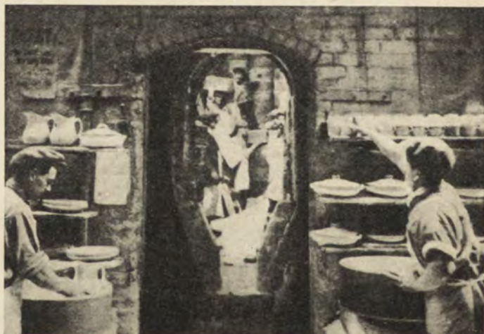
(c) Przez otwór widzimy wnętrze pieca do wypalania. Robotnicy wkładają garnki i talerze do naczyń (kamiennych i czerwonych). Robotnicy wewnątrz pieca ustawiają w stopy naczynia na odpowiednie miejsca.
