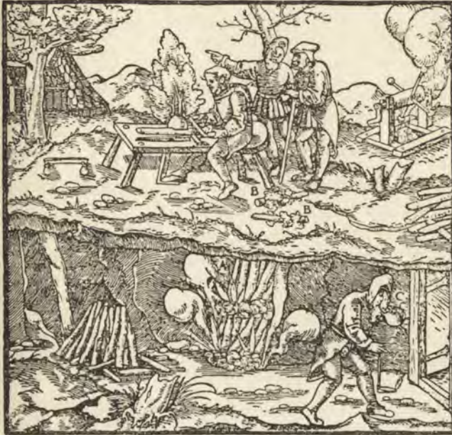
Fig. 56. — Rozbijanie skał zapomocą kolejnego działania ognia i wody. Robotnik u góry nakłada wióry na każdą wiązkę chróstu. U dołu robotnik po zapaleniu ognia ucieka przed dymem. . (Rysunek z książki Agricoli).
