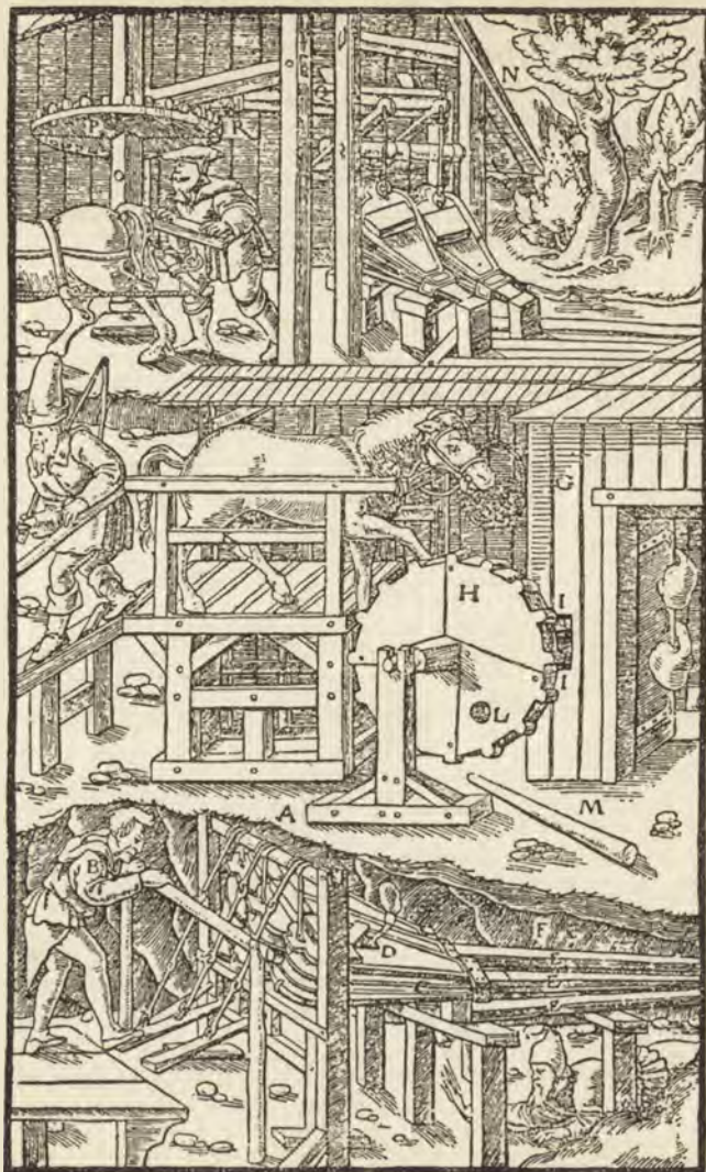
Fig. 55. — Różne sposoby doprowadzania powietrza do kopalni. (Agricola).
