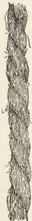
Fig. 34. — Stosunek między skręceniem włókien w pojedynczem paśmie do skręcenia dwóch pasm jest taki, że włókna biegną równoległe do osi pasma podwójnego.
