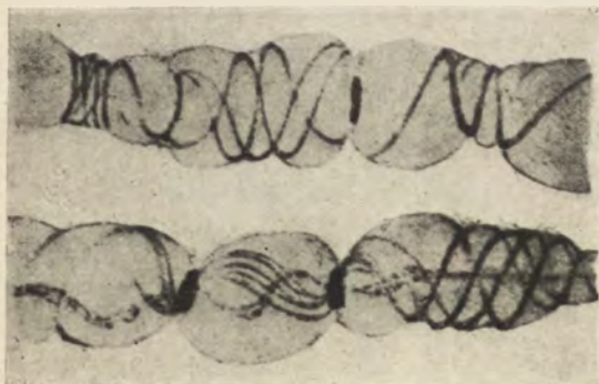
(c) Spirala, pokryta płaszczem z włókien bawełny (w danym przypadku naciągnięta do granicy zerwania).
