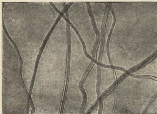
(b) Włókna bawełny po merceryzacji. Kształt przekroju włókien jest bardziej okrągły, niż na rysunku (a).
