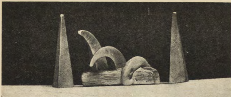
(a) Stozki Segera. Są one wykonane z gliny o różnym składzie i uszeregowane tak, że zaczynają topnieć przy różnych stopniach nagrzania. Trzy środkowe stozki były już w piecu: stozek na lewo zaczął mięknąć, środkowy zgiął się, prawy upadł. Ze stanu tych trzech stozków wynioskowano, że wypalenie naczyń, znajdujących się w piecu było dostateczne. Dwa stozki znajdujące się po bokach nie były w piecu.
