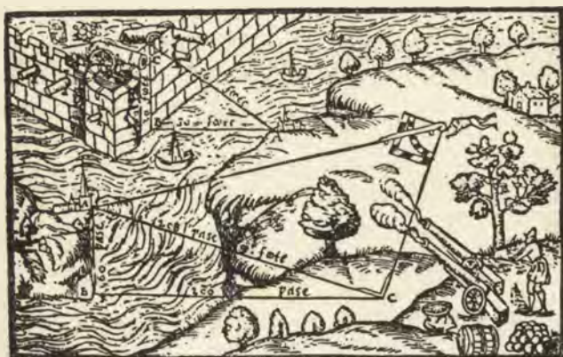
Fig. 5. — Pomiary zapomocą prostego kwadranta, uskutecznia- ne podczas wojny.
