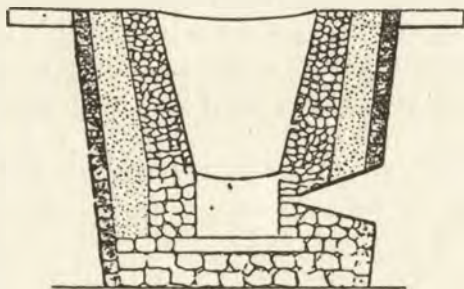
Fig. 15. — Piec osmundzki (z 18 wieku). Należy zwrócić uwagę na grube ściany, pokryte zewnątrz belkami drewnianymi i wylot, przez który wypływa stopiony metal. Patrz również tabl. VI, c. (Z „ Metallurgy, Iron and Steel “ Percy'ego).
