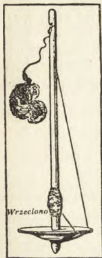
Fig. 23. — Wrzeciono. Po lewej stronie widzimy motek wełny, przeznaczony do przedzenia. Podczas obrotu wrzeciona wełna zwisa na nawpół przygotowanej nici, którą następnie przedzie się w celu dobrego skręcenia jej.
