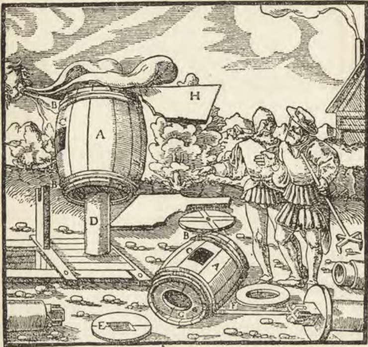
Fig. 54. — Wentylator, według Agricoli. Należy zwrócić uwagę na wiatr po lewej stronie rysunku.
