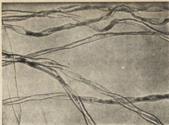
(a) Włókna bawełny przed merceryzacją. Są one podobne do tasiemki i zawierają liczne węzłki.
