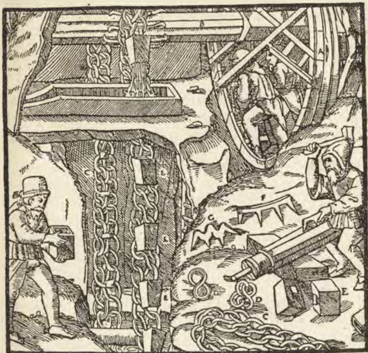
Fig. 45. — Wydobywanie wody zapomocą kublów, zawieszonych na łańcuchu, poruszającym przez kołowrót. Na pierwszym planie widzimy jednego człowieka, niosącego świeży kubel i drugiego, który wbija skobel ( F lub G ) w beczkę ( B ).
