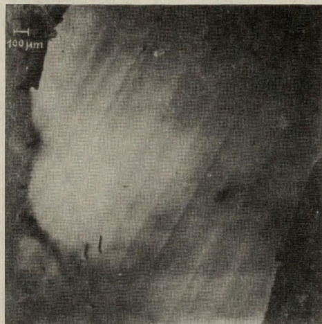
Rys. 5. Przykłady obrazów EBIC na płytce o płaszczyźnie (110) równoległej do kierunku wzrostu monokryształu Si domieszkowanego metodą NTD
