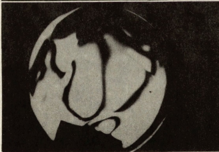
Rys. 6. Polaryskopowe obrazy naprężeń w płytce Si nr 14-7 BI uzyskane podczas obrotu płytki wokół osi o kąt /względem centralnego położenia/ zaznaczony na rysunku
