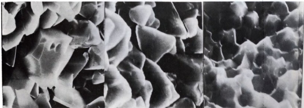
Rys. 15. Kryształy cBN na powierzchni przełomu. Obrazy otrzymane za pomocą elektronów wtórnych w skaningowym mikroskopie elektronowym. http://rcin.org.pl
