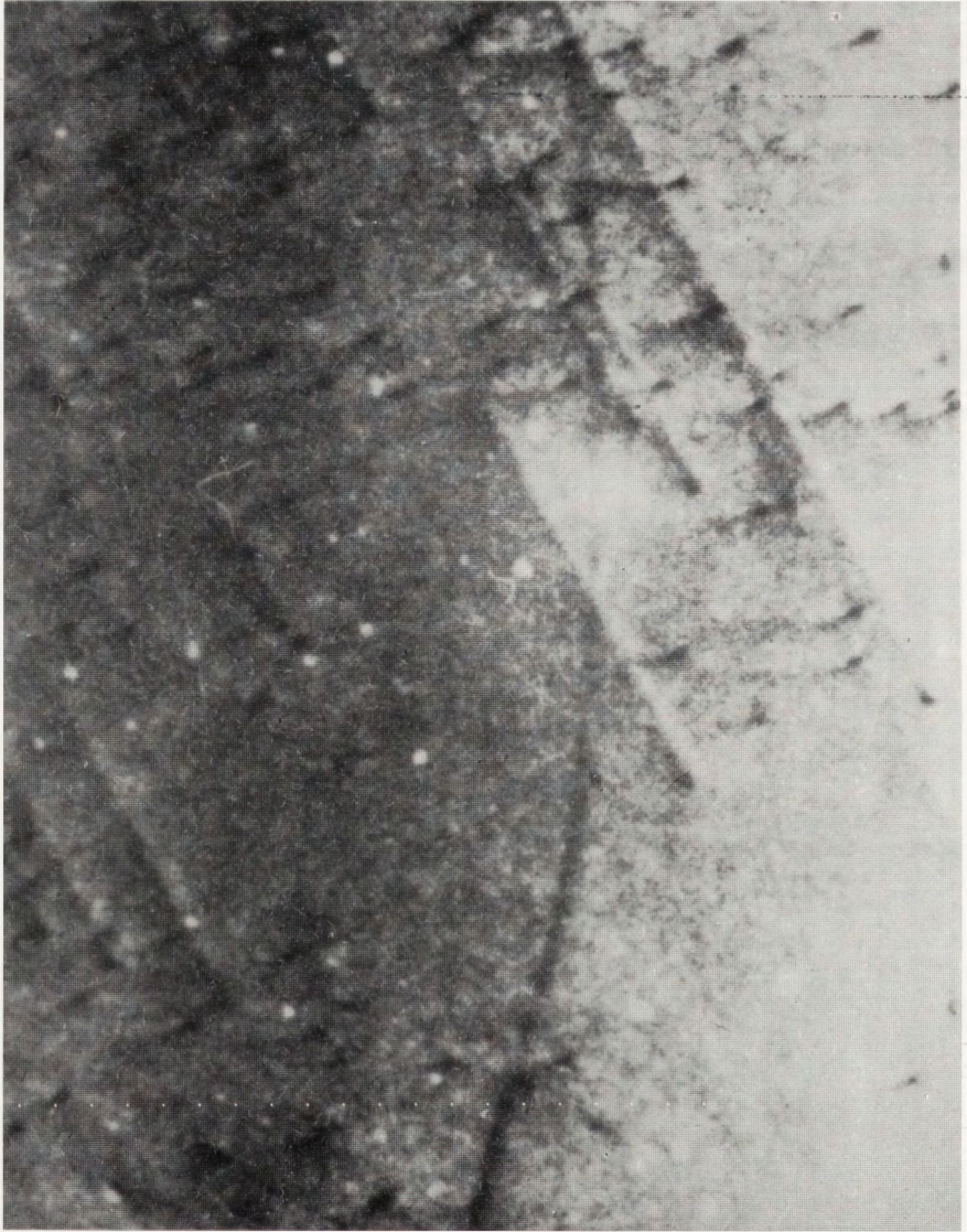
Rys. 16. Przykłady odwzorowań dyslokacji niedopasowania lub ich zakończeń uzyskane za pomocą metody Berga-Barretta w przypadku warstw epitaksjalnych o znacznej grubości c) próbka z serii 5 ( t_w = 50 \mu\text{m} ), refleksy 531 i 511
