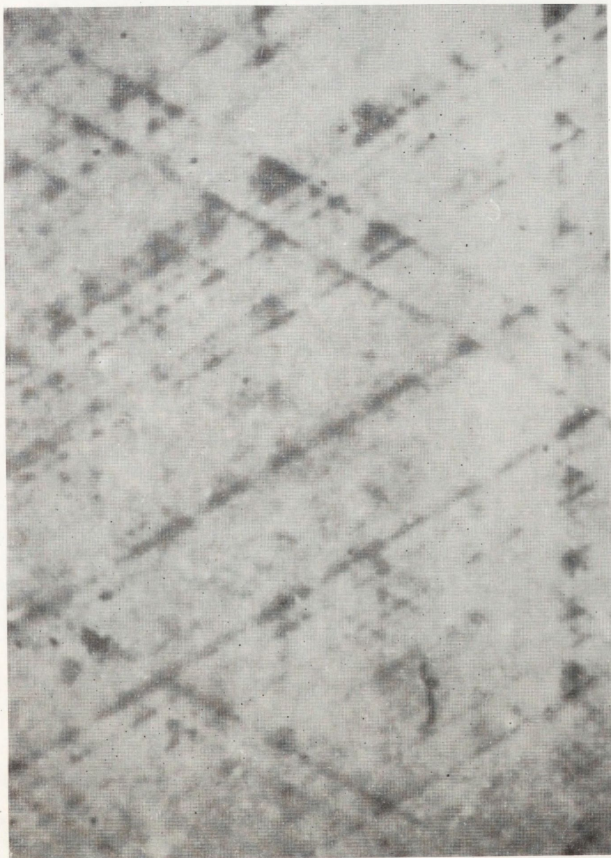
Rys. 16. Przykłady odwzorowań dyslokacji niedopasowania lub ich zakończeń uzyskane za pomocą metody Berga-Barretta w przypadku warstw epitaksjalnych o znacznej grubości b) próbka z serii 2 ( t_w = 40 \mu\text{m} ), refleksy 333 i 511
