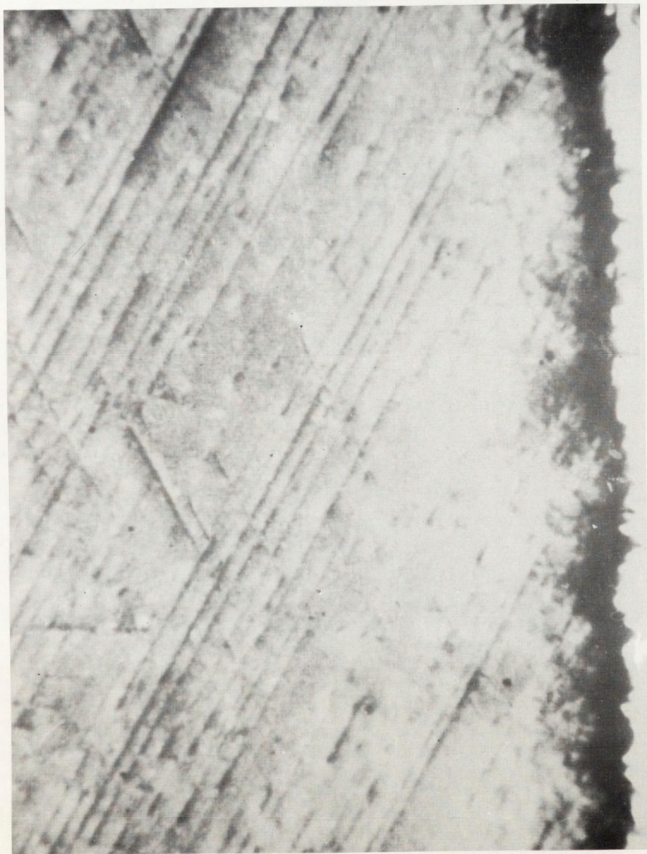
Rys. 17. Przykłady odwzorowań dyslokacji niedopasowania uzyskanych za pomocą metody Berga-Barręta w przypadku warstw epitaksjalnych o znacznym rozmyciu złącza (próbki po wygrzewaniu) a) próbka z serii 4b ( t_w = 15 \mu\text{m} ), refleks 620
