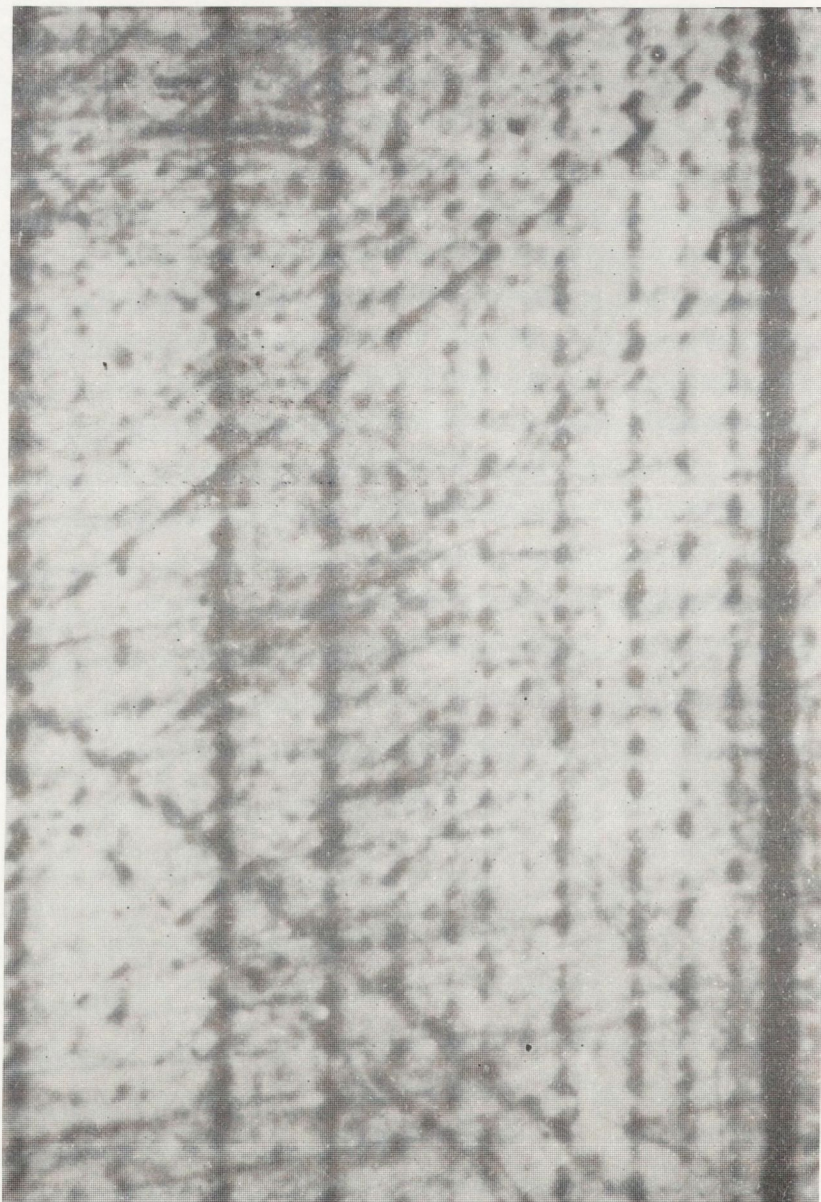
Rys. 16. Przykłady odwzorowań dyslokacji niedopasowania lub ich zakończeń uzyskane za pomocą metody Berga-Barretta w przypadku warstw epitaksjalnych o znacznej grubości a) próbka z serii 2 ( t_w = 40 \mu\text{m} ), refleksy 333 i 511
