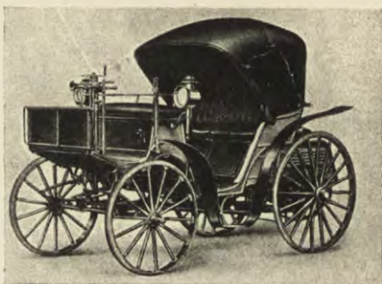
JEDEN Z PIERWSZYCH AUTOMOBILÓW — KONSTRUKCJA JEGO NIE ODBIEGA W NI- CZEM PRAWIE OD KONSTRUKCJI ZWY- KLEGO POWOZU
