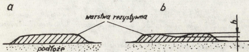
Rys. 29. Zmiana profilu warstwy po próbie ścierania ślizgaczem potencjometru a) profil warstwy przed próbą, b) profil warstwy po próbie
