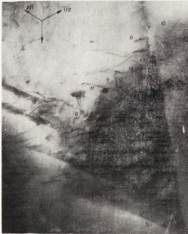
Rys. 24. Dyslokacje i płaszczyzny poślizgu dyslokacji. Próbka 550R
