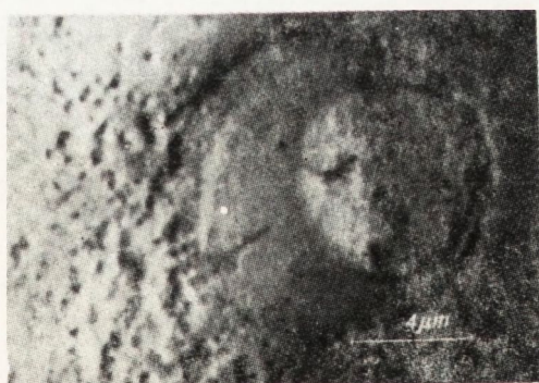
Rys. 26. Obraz mikroskopowy kolonii wydzieleni obserwowanych w próbce A1
