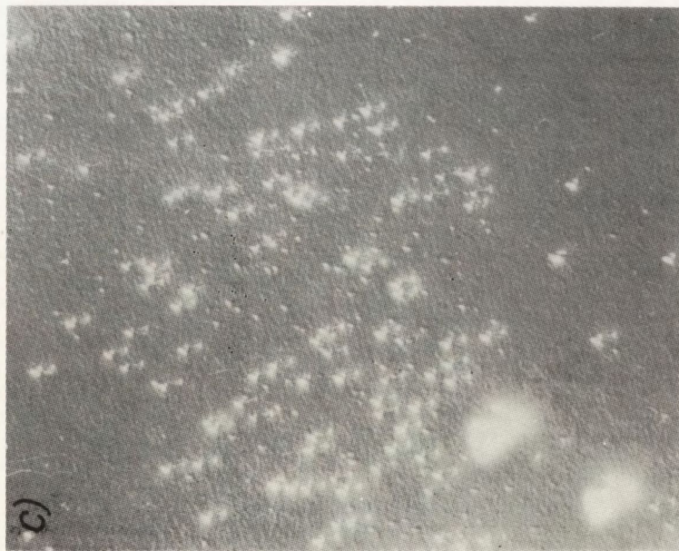
Rys. 12. Zależność morfologii powierzchni warstwy od typu kontroli szybkości wzrostu /warstwa P3 otrzymana przy typie kontroli szybkości wzrostu przez procesy powierzchniowe, rys. 9/. Pow.: a/ x150, b/ x310, c/ x150, d/ x310
