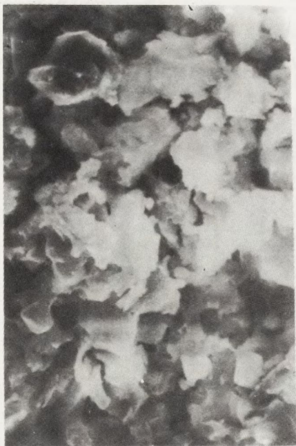
Rys. 12 i 13. Zdjęcia scanningowe powierzchni próbki ceramicznej po strawieniu warstwy metalizacji WMn szkło litowe spiekanej w 1272°, 28°C
