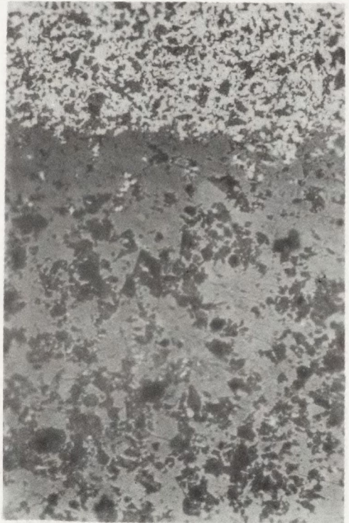
Rys. 4. Struktura złącza ceramika-metalizacja MoMnFeSi szlif skośny warunki spiekania metalizacji 1330°C, 25°C
