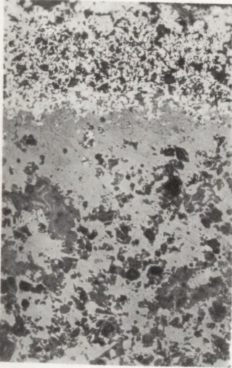
Rys. 4. Struktura złącza ceramika-metalizacja MoMnFeSi szlif skośny warunki spiekania metalizacji 1330°C, 25°C
