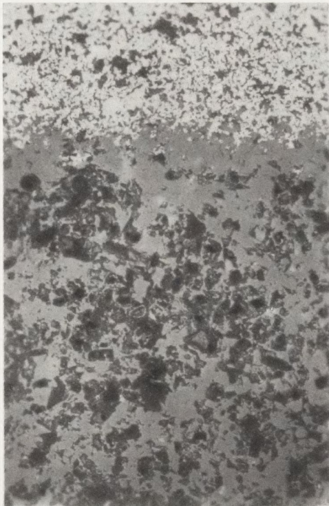
Rys. 6. Struktura złącza ceramika-metalizacja MoMnFeSi szlif skośny, warunki spiekania metalizacji 1272°C, 18°C
