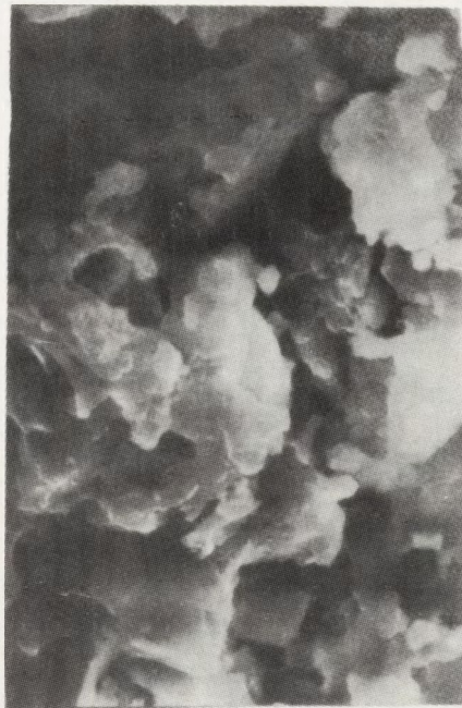
Rys. 12 i 13. Zdjęcia scanningowe powierzchni próbki ceramicznej po strawieniu warstwy metalizacji WMn szkło litowe spiekanej w 1272°, 28°C
