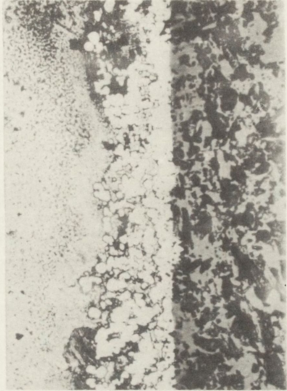
Rys.7. Struktura złącza ceramika-miedź uzyskanego przez zgrzewanie dyfuzyjne z przekładką Ti /pow. 500x/
