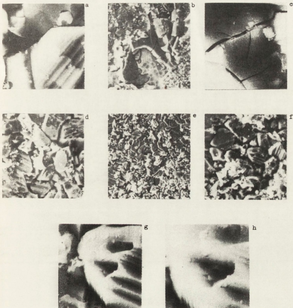
Rys.44. Struktura podłoża ceramicznego po spiekaniu przez 1 h w temperaturze 1300^{\circ}\text{C} i po usunięciu warstwy \text{MoMnFeSi} i warstwy pośredniej. Na mikrofotografiach a, b, c widoczne mikropęknięcia. Na mikrofotografiach a, b, d, e, f, g, h widoczne trwałe ubytki w masie ziaren oraz ukierunkowana topografia powierzchni
